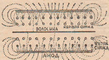
Рис. 4. Розріз електродів двосітки та силової лінії анода
