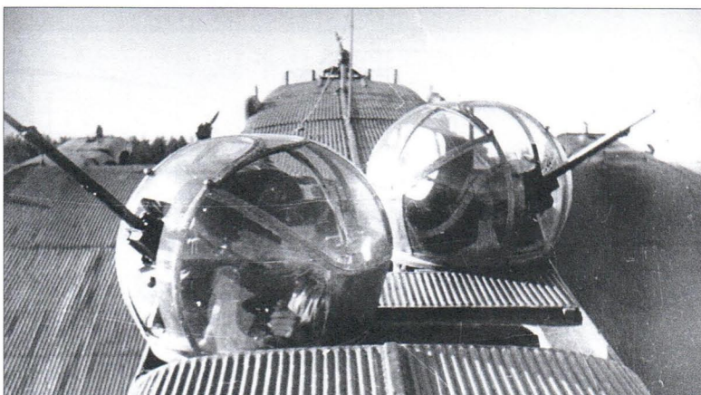
Турельные установки УТК-1 с пулемётом УБТ калибра 12,7 мм монтировались в годы войны лишь на отдельных экземплярах ТБ-3
