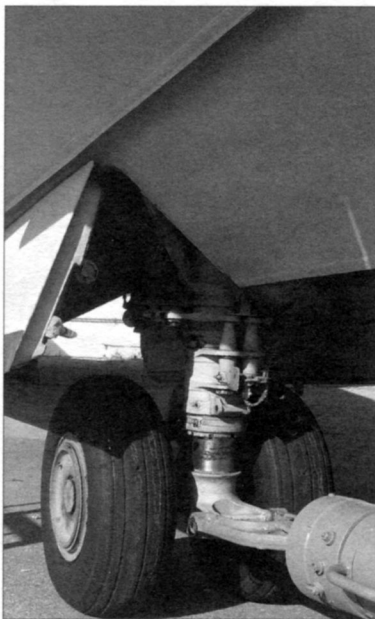
Носовая (слева) и основная опоры шасси амфибии А-40
