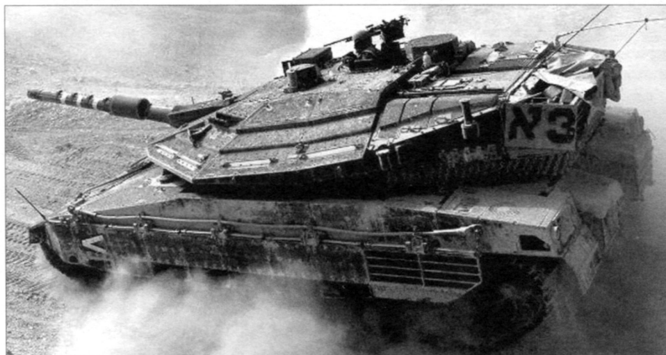
Плоская башня «Меркавы» Mk.4 – внешний отличительный признак от её предшественников
