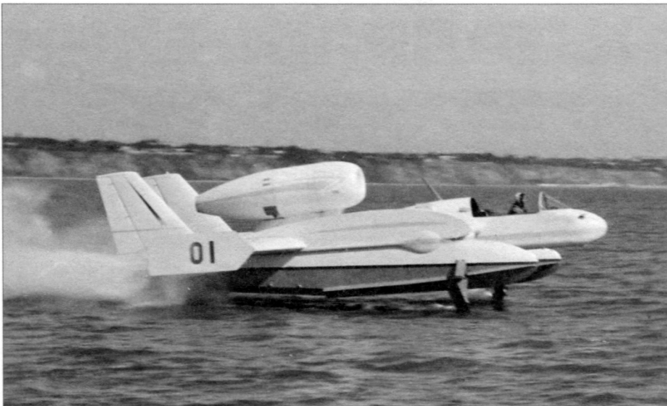
Бе-1 на подводных крыльях
