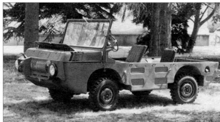
Армейский полноприводной автомобиль-амфибия ЛуАЗ-967 ТПК — прямой предшественник гражданского мини-джипа ЛуАЗ-969
