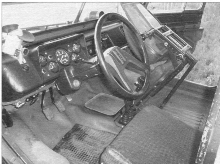
Органы управления и приборная доска ЛуАЗ-969М
