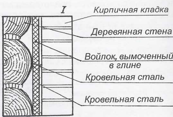
Рис. 4. Устройство камина пристенного типа: а — фасад; б — разрез
