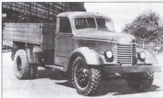
Бортовой грузовой автомобиль ЗиС-150 первых лет выпуска с кабиной смешанной деревянно-металлической конструкции и деревянным кузовом
