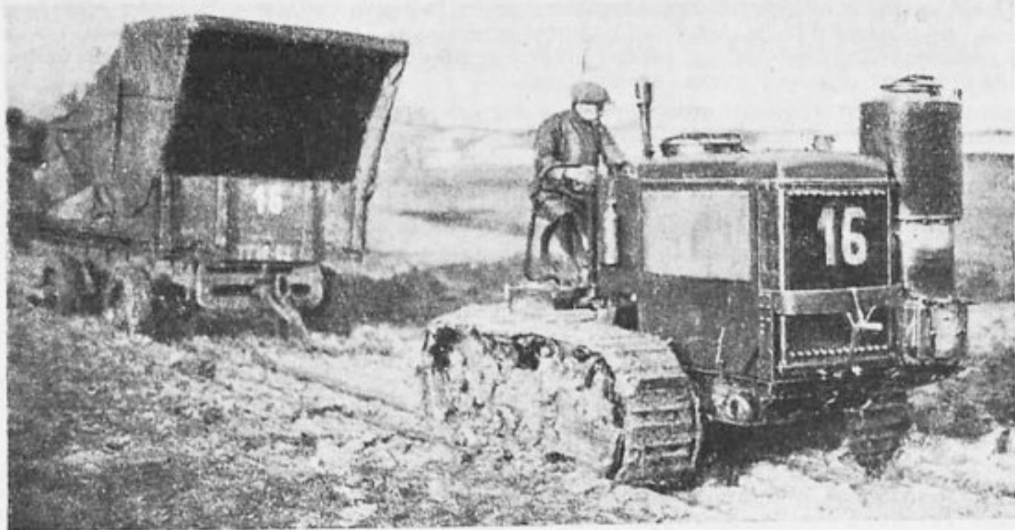
Гусеничный трактор Рено с газогенератором той же фирмы
