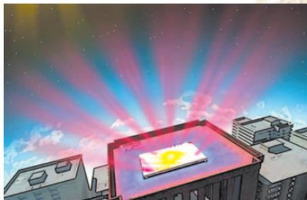
Амальгама зеркала толщиной в 2 микрона состоит из нескольких слоев: серебра (светоотражающий слой) и «чересполосицы» двуокиси кремния и окиси гафния. Последние два материала и превращают зеркало в термоизлучатель: когда двуокись кремния нагревается, она начинает излучать тепло в виде инфракрасного света с длиной волны порядка 10 микрон. Такое излучение атмосфера Земли практически не поглощает, и в результате тепло уходит в межпланетное пространство.
