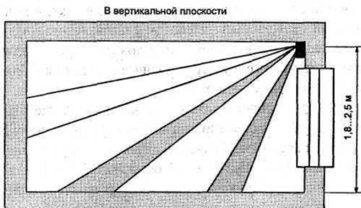
*Рис. 11. Схемы защиты помещений с помощью оптико-электронных инфракрасных пассивных извещателей*
