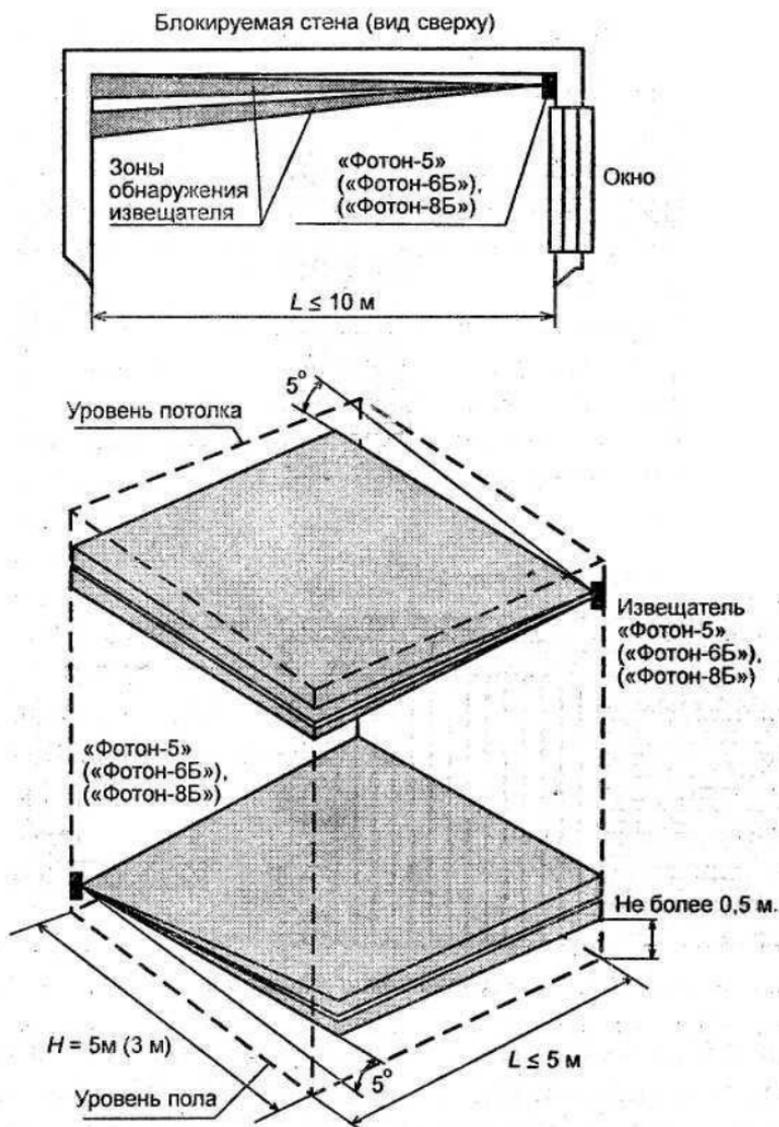
Рис. 10. Схемы блокировки стен, потолков и полов с помощью пассивных извещателей с узконаправленной зоной обнаружения
