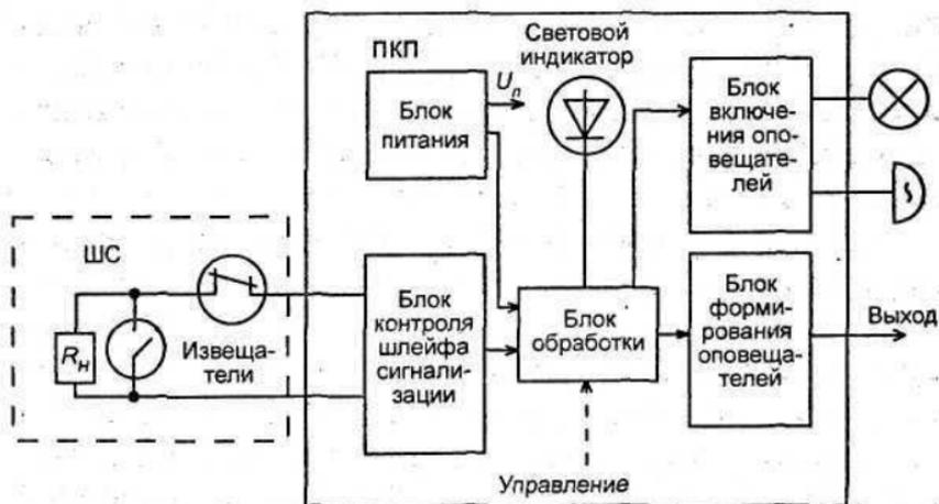
Рис. 17. Схема приемно-контрольного прибора малой информационной емкости
