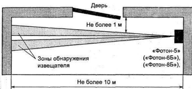
Рис. 7. Схема блокировки дверей с помощью извещателей «Фотон»
