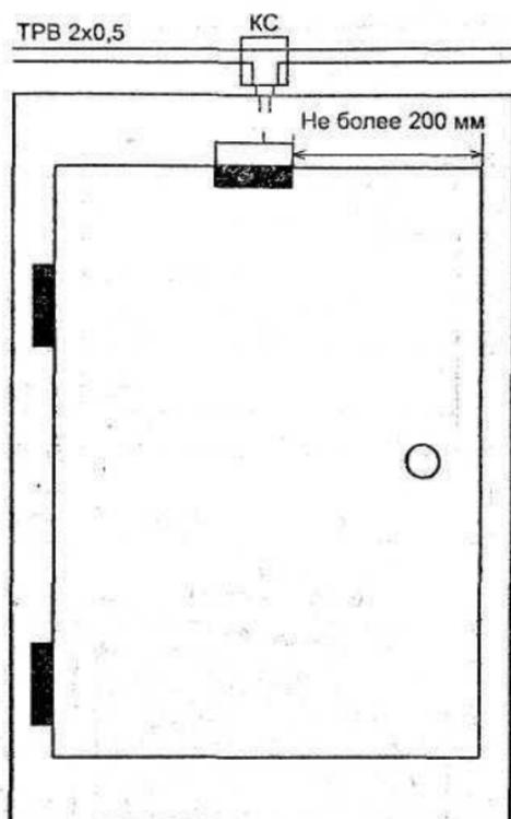
Рис. 5. Схема блокировки дверей с помощью магнитно-контактного извещателя
