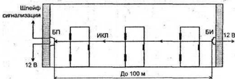
Рис. 6. Схема блокировки нескольких дверей (например в коридоре) с помощью оптико-электронных инфракрасных извещателей: БП — блок приемника; БИ — блок излучателя инфракрасных лучей (ИКЛ)
