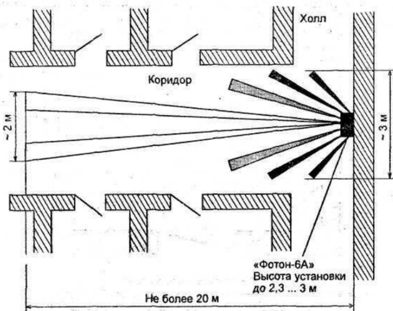
Рис. 13. Схема блокировки коридора с помощью оптико-электронных пассивных извещателей с линейной зоной обнаружения
