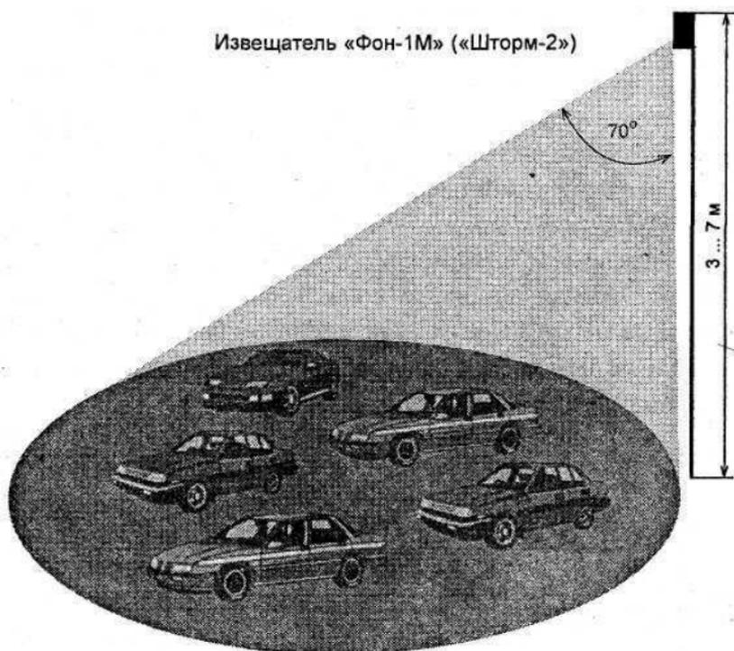
*Рис. 16. Схема блокировки открытой площадки*
