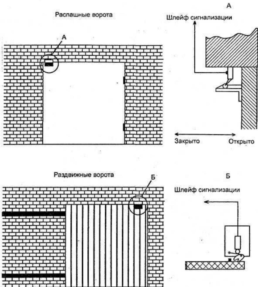
Рис. 9. Схема блокировки ворот
