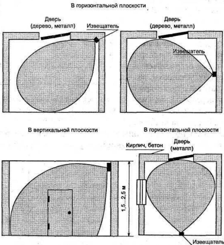
Рис. 8. Схемы блокировки дверей с помощью ультразвуковых, радиоволновых и комбинированных извещателей
