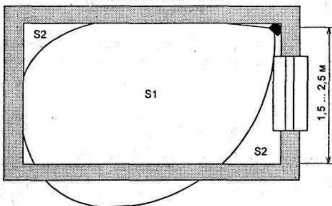
*Рис. 12. Схемы защиты помещений с помощью радиоволновых и ультразвуковых извещателей: S1 — зона обнаружения; S2 — мертвая зона*
